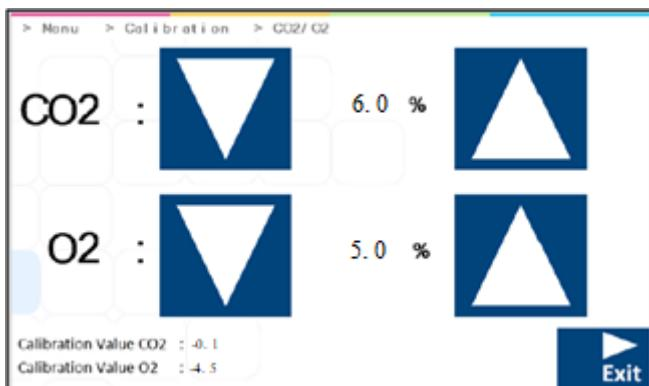
Εικόνα 13.24 Βαθμονόμηση των CO<sub>2</sub> και O<sub>2</sub> στους επωαστήρες εξωσωματικής γονιμοποίησης πολλαπλών θαλάμων MIRI® TL6 και MIRI® TL12
