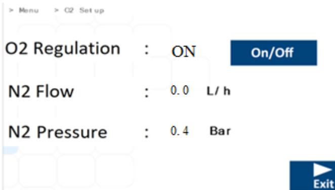
**Εικόνα 13.26** Υπομενού ρύθμισης O<sub>2</sub> επωαστήρων εξωσωματικής γονιμοποίησης πολλαπλών θαλάμων MIRI® TL6 και MIRI® TL12
