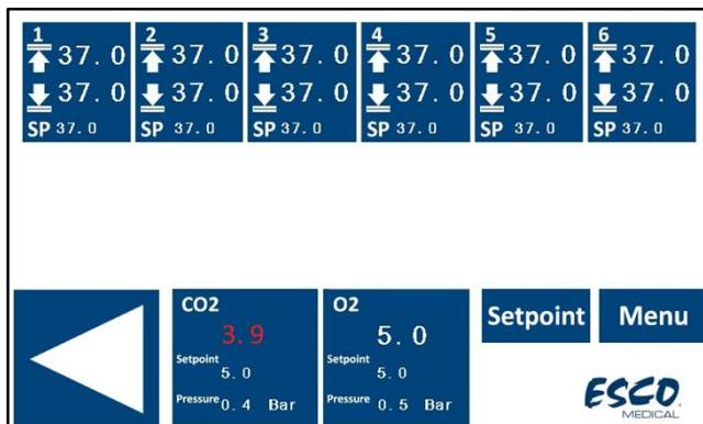
**Εικόνα 14.5** Συναγερμός χαμηλής συγκέντρωσης CO<sub>2</sub> στην αρχική οθόνη του επωαστήρα εξωσωματικής γονιμοποίησης πολλαπλών θαλάμων MIRI® TL6
