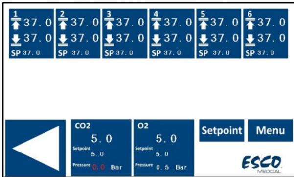
**Εικόνα 14.7** Συναγερμός πίεσης αερίου CO<sub>2</sub> στην αρχική οθόνη του επωαστήρα εξωσωματικής γονιμοποίησης πολλαπλών θαλάμων MIRI® TL6
