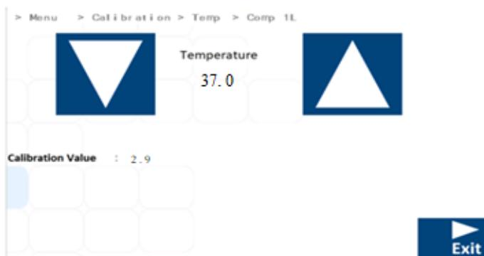
**Εικόνα 13.23** Βαθμονόμηση ζώνης 1 στους επωαστήρες εξωσωματικής γονιμοποίησης πολλαπλών θαλάμων MIRI® TL6 και MIRI® TL12
