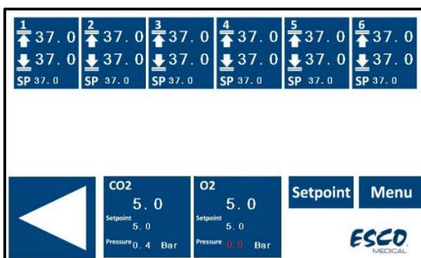
**Εικόνα 14.8** Συναγερμός πίεσης αερίου N<sub>2</sub> στην αρχική οθόνη των επωαστήρων εξωσωματικής γονιμοποίησης πολλαπλών θαλάμων MIRI® TL6
